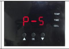
Si se pulsa OK durante 5 segundos se activará el modo P5 para calibrar posibles diferencias entre la tempertura real y la temperatura programada. En el modo P5 utilice las flechas para corregir la diferencia a +/-20.
