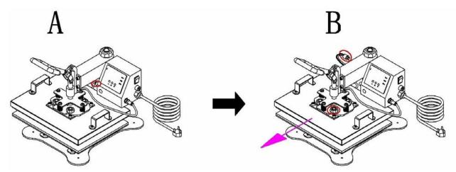
Desenchufa el conector del lado izquierdo pero mantén enchufado el conector del lado derecho. Retira los cuatro tornillos (imagen B). Extrae el plato superior.
