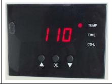
Pulsa el botón OK y se encenderá la temperatura. Utiliza las flechas para ajustar la temperatura al valor deseado.
