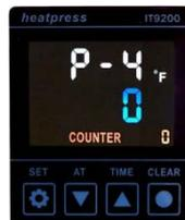
Pulsa SET para activar la corrección de temperatura, y utiliza ↓ para reducir la temperatura al valor real de medición o ↑ para incrementarlo.
