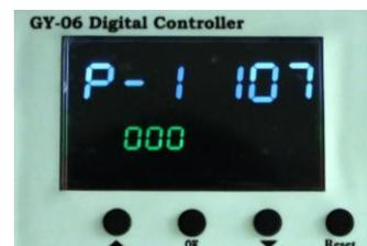
Presionar el botón OK durante 5 segundos para activar el modo de reinicio, cuando la temperatura de la pantalla sea distinta a la temperatura real del plato:
