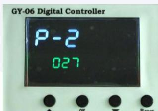
Cuando SV y PV difieren mucho, se recomienda presionar el botón OK durante 5 segundos. Presionar nuevamente para calibrar la temperatura. Si la diferencia entre SV y PV es de 20 grados, pulsar "Δ" o "▽" para ajustar el valor a 20.
