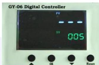
Pulsar el botón OK después de ajustar la temperatura y la luz de temperatura se encenderá. Configurar el tiempo con las flechas según las instrucciones.
