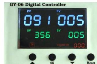
Volver a presionar OK para activar el modo de funcionamiento. El contador tiene un rango de 0~999. Pulsar "Reset" durante 5 segundos para configurar el contador a "0".
