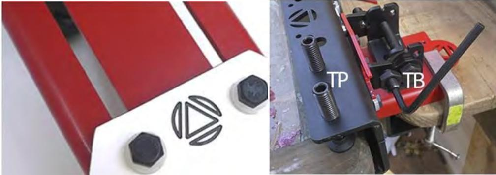
12. Colocar la tabla con los 2 tornillos largos, sus arandelas y sus tuercas.
