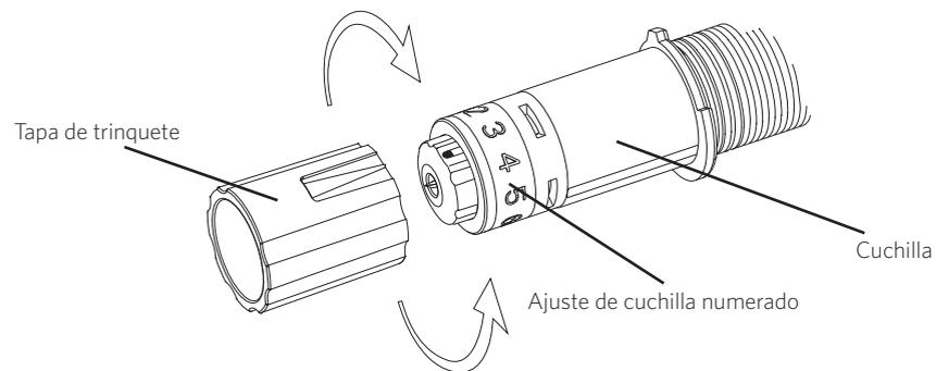
Desbloquee la boquilla de la cuchilla girando la palanca de cierre en sentido contrario a las manecillas del reloj. Coloque el soporte de la cuchilla en la boquilla de la cuchilla y gire la palanca de cierre en sentido de las manecillas del reloj para asegurar la cuchilla. Asegúrese de que el soporte de la cuchilla esté completamente dentro de la boquilla.
