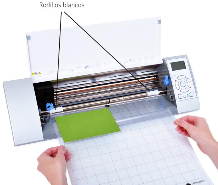
Introduzca el tapete de corte dentro de Silhouette levantando la tapa, coloque el tapete centrado entre los rodillos blandos y pulse el botón Intro (mientras está seleccionado "Cargar tapete de corte" en la pantalla LCD).
