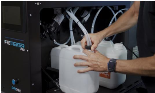
Fig.13: Retirando los tubos del tanque.
