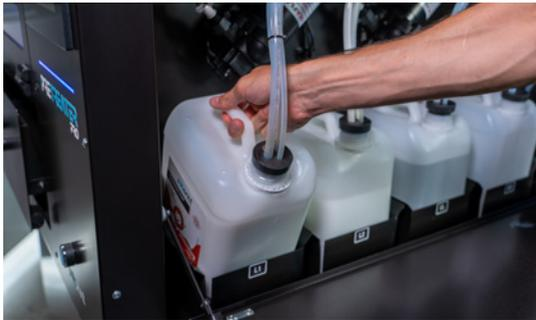
Fig.16: Colocando el tanque dentro de la bandeja.
