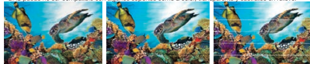
Posición de caída de gota bidireccional incorrecta
