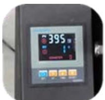
4. Pulsa SET para finalizar el ajuste. Abre la plancha y coloca la prenda y pulsa el controlador.
