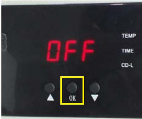
Pulsa el interruptor para encender la plancha, y se encenderá el piloto luminoso de temperatura. El visualizador digital indica OFF.
