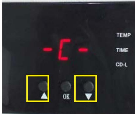
Pulsa el botón OK, el visualizador indica C que se refiere a grados centígrados. Pulsa las flechas ^ o v para seleccionar "C" para medir la temperatura en grados centígrados o "F" para Farenheit.
