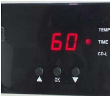
Después de ajustar la temperatura, pulsa el botón OK y se encenderá el piloto luminoso correspondiente al tiempo. Pulsa las flechas ^ o v para configurar el tiempo según las instrucciones del producto.
